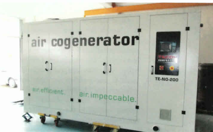
Eine 200 kW KWK-Druckluft+ Anlage bei der Auslieferung zum Endkunden.
